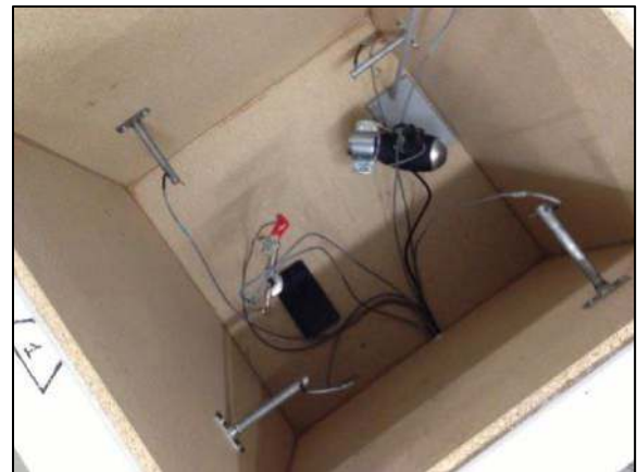
Abbildung 12: Fühlerplatzierung und Wärmequellenposition (Föhn)
