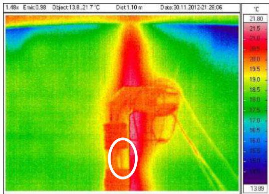
Abbildung 50: Oberflächentemperaturen Rauchrohr (Ansicht von Vorne)
