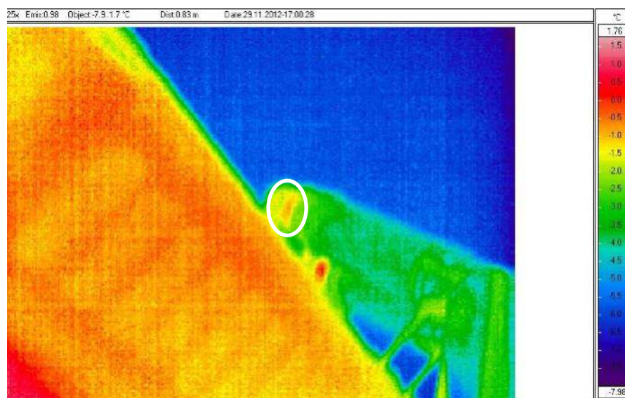
Abbildung 52: Oberflächentemperaturen des gedämmten Rauchrohres im Freien
