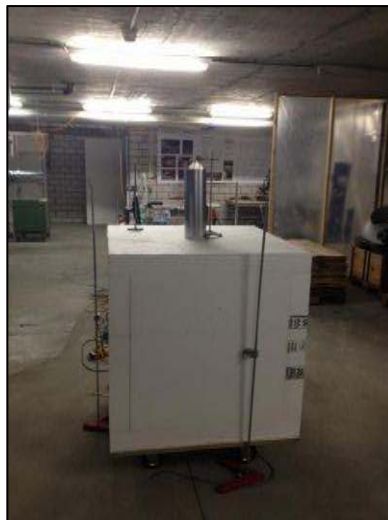
Abbildung 56: Ansicht Prüfbox mit eingebauter Funktionsöffnung
