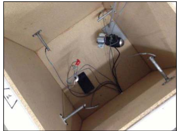
Abbildung 55: Fühlerplatzierung und Wärmequellenposition (Föhn)
