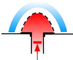
Wenn kein Regenwasser abfließt, werden Energieverluste durch die geschlossenen Membranen verhindert.
