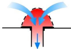
Bei zufließendem Regenwasser öffnen sich die Membranen und das Wasser fließt ab.
