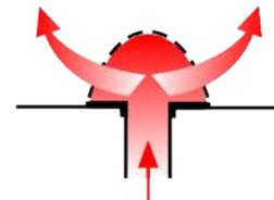
Überdruck aus der Kanalisation wird durch Öffnen, spezieller Membranen ausgeglichen.
